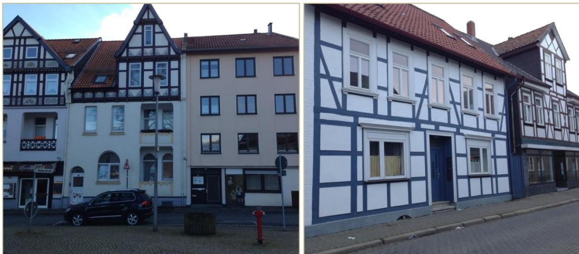
Abbildung 28: Massivbauten und Fachwerk
